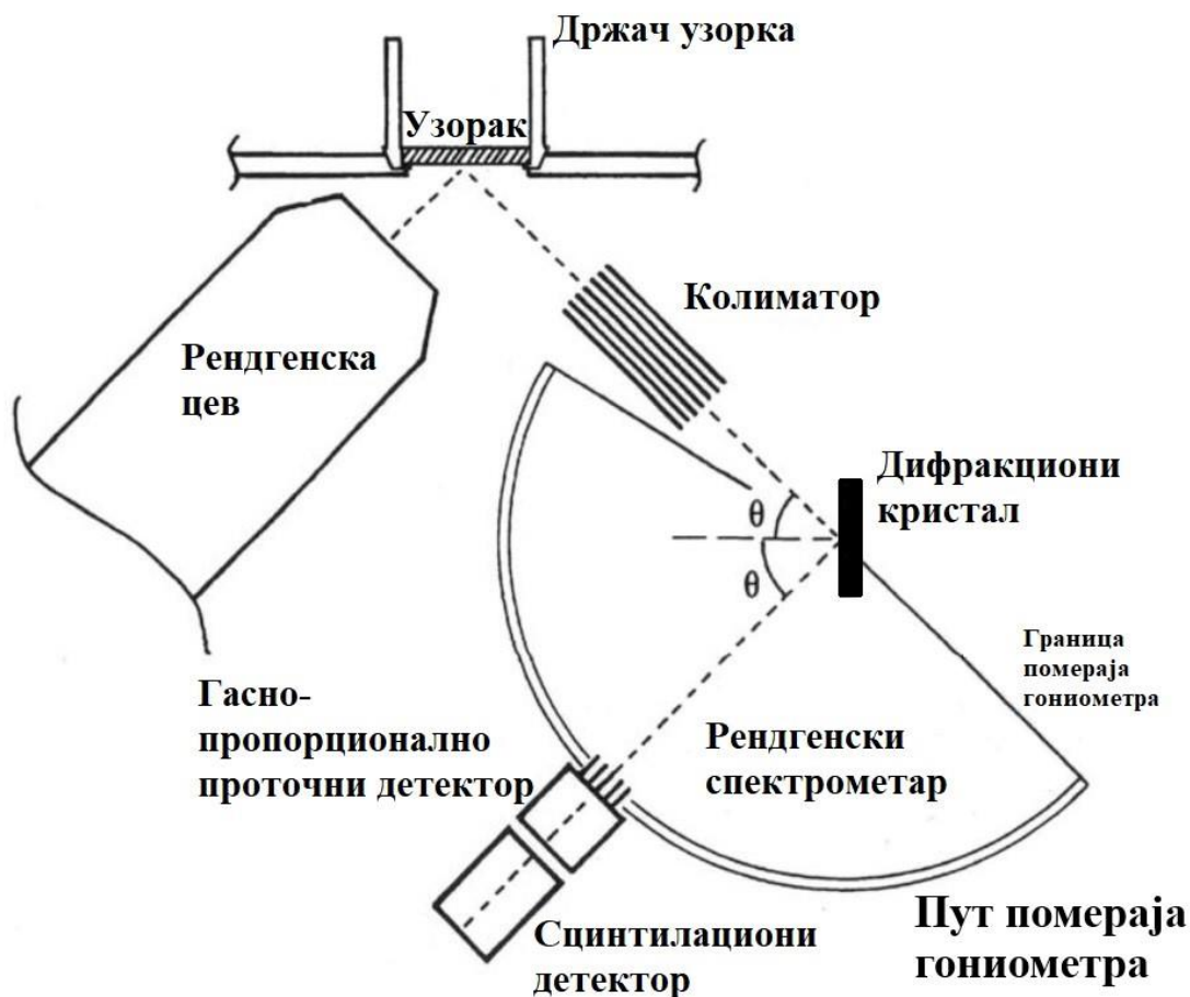
Слика 2.12. Шематски прилаз таласно дисперзивно рендгенско флуоресцентног спектрометра. (прилагођено према Gauglitz и Vo-Dinh, 2003)
