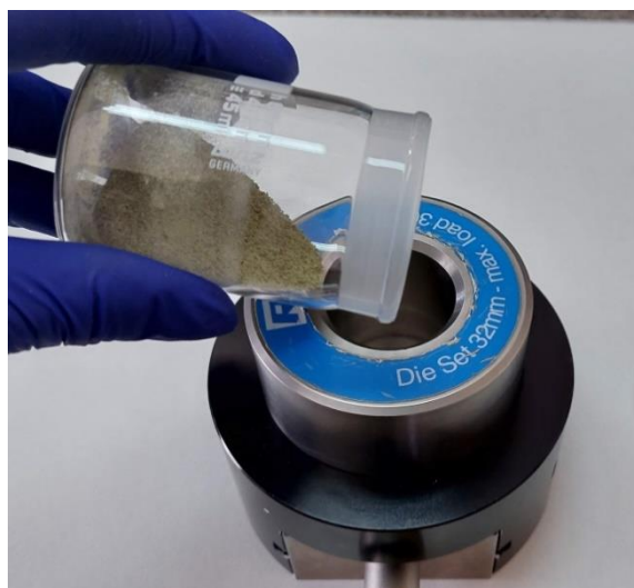
Слика 4.9 Уношење хомогене смеше биљног узорка и воска у носач узорка пресе.
