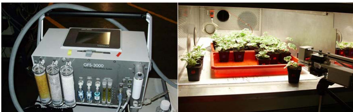
Slika 3.10. Levo: centralna jedinica portabl aparata za analizu gasova i merenje fluorescencije GFS-3000 (Heinz Walz GmbH). Desno: merenje izmene gasova listova P. zonale u kivetu za merenje unutar komore SSZ.
