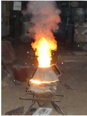
Slika 3.- Metalotermijska reakcija Figure 3.- Metallothermic reaction
