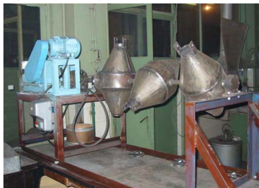
Slika 2.- Homodenizacija komponenti aluminotermijskih mešavina Figure 2.- Homogenization of components of aluminothermic mixtures
