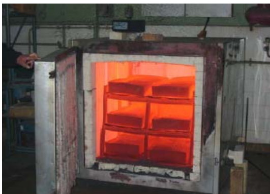
Slika 1.- Oksidaciono žarenje sirovina Figure 1.- Oxidation annealing of raw materials
