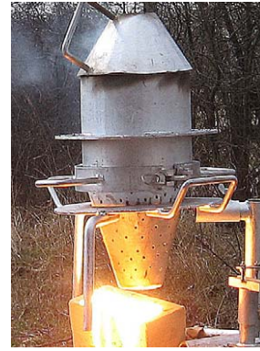
Slika 4.- Izlivanje u kalup Figure 4.- Casting into mould
