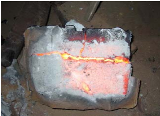
Slika 5.- Kontakt produkata reakcije (troska-feroledura) Figure 5.- Contact of reaction products (sand blast-ferroalloy)
