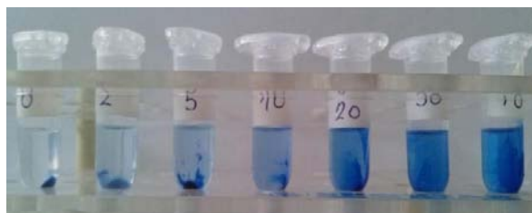
Slika 4.54. Fotografija enzimskog testa za ispitivanje pululanazne aktivnosti pomoću konjugata pululan – RBBR kao hromogenog supstrata
