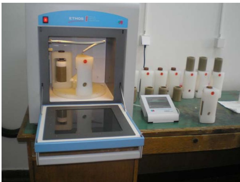
Slika 28. Mikrotalasni digestor MILESTONE ETHOS 1.
