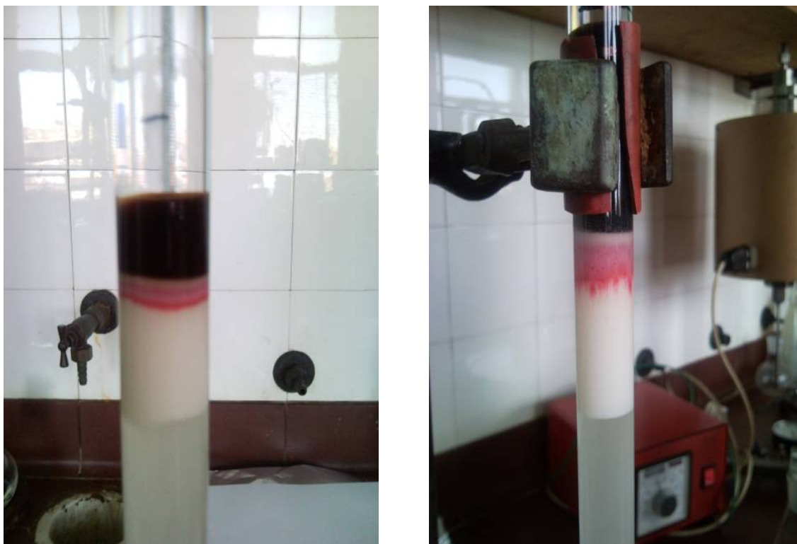
Slika 26. Hromatografske kolone sa formiranim adsorpcionim stubom i nanetim uzorkom bitumena.
