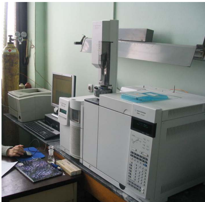
Slika 27. Gasnohromatografsko- masenospektrometrijski (GC-MS) sistem.
