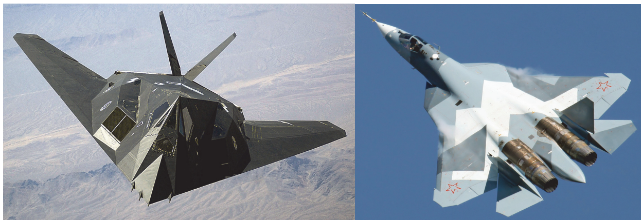
Слика 4: “STEALTH” летелице различитих генерација F-117 (лево) и СУ Т-50 (десно) имају смањену рефлексију радарског зрачења
