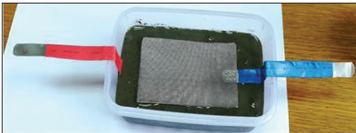
Slika 1. Izgled formirane MFC, sediment između dve inoks elektrode.
