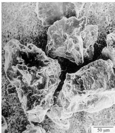
Slika 3. Prah disperzno ojačanog bakra proizveden mlevenjem (Mitkov et al., 1998)
